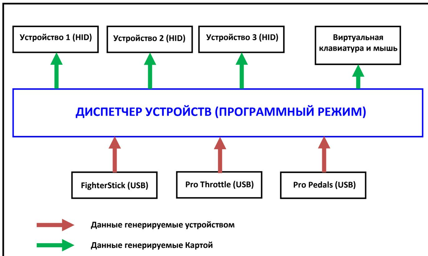
В ГИП Диспетчера создаётся **Карта**. Она определяет, какие кнопки и оси устройства HID соответствуют каким кнопкам и осям на устройствах USB. В Программном режиме, есть также виртуальная клавиатура и мышь, для того чтобы кнопки и оси могли быть запрограммированы на ввод символов и использование функций мыши. Данные генерируемые устройствами (*показанные красным*) обрабатываются алгоритмами заданными в Диспетчере и трансформируются в данные генерируемые Картой (*показаны зелёным*).
